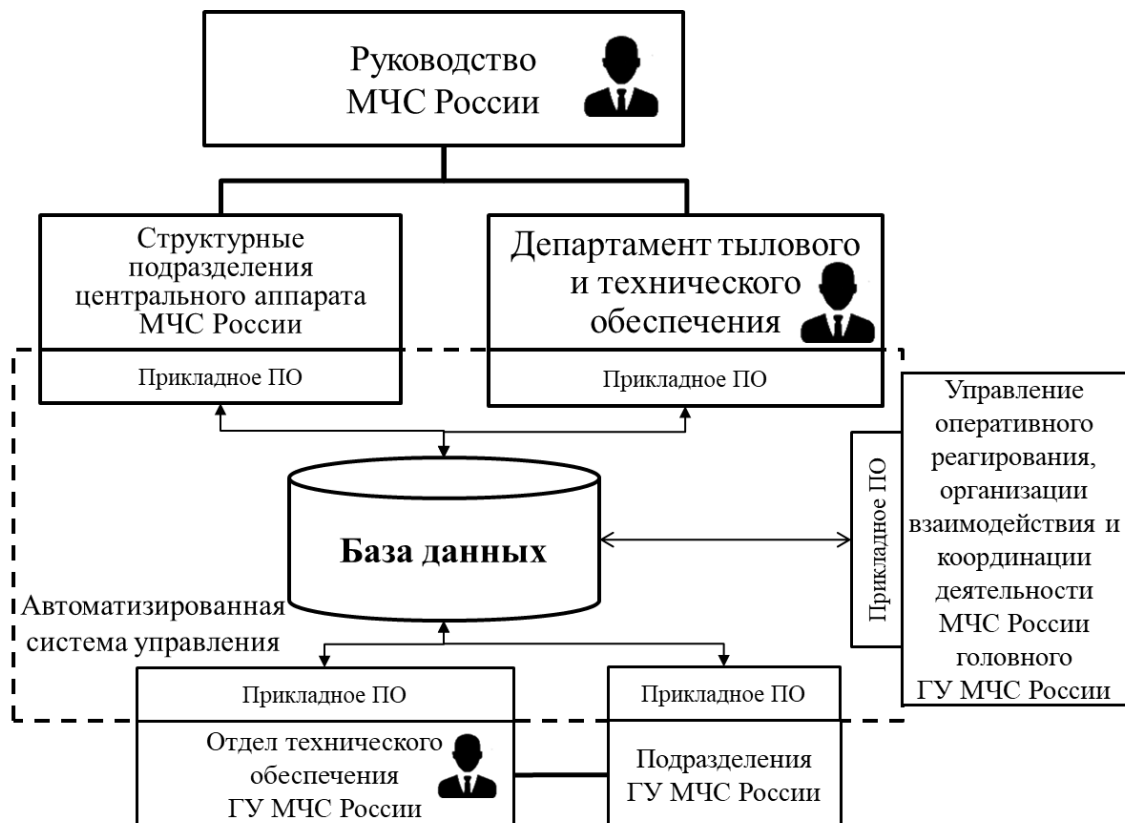
Рисунок 4.3 – Схема автоматизированной системы управления техническим обеспечением
