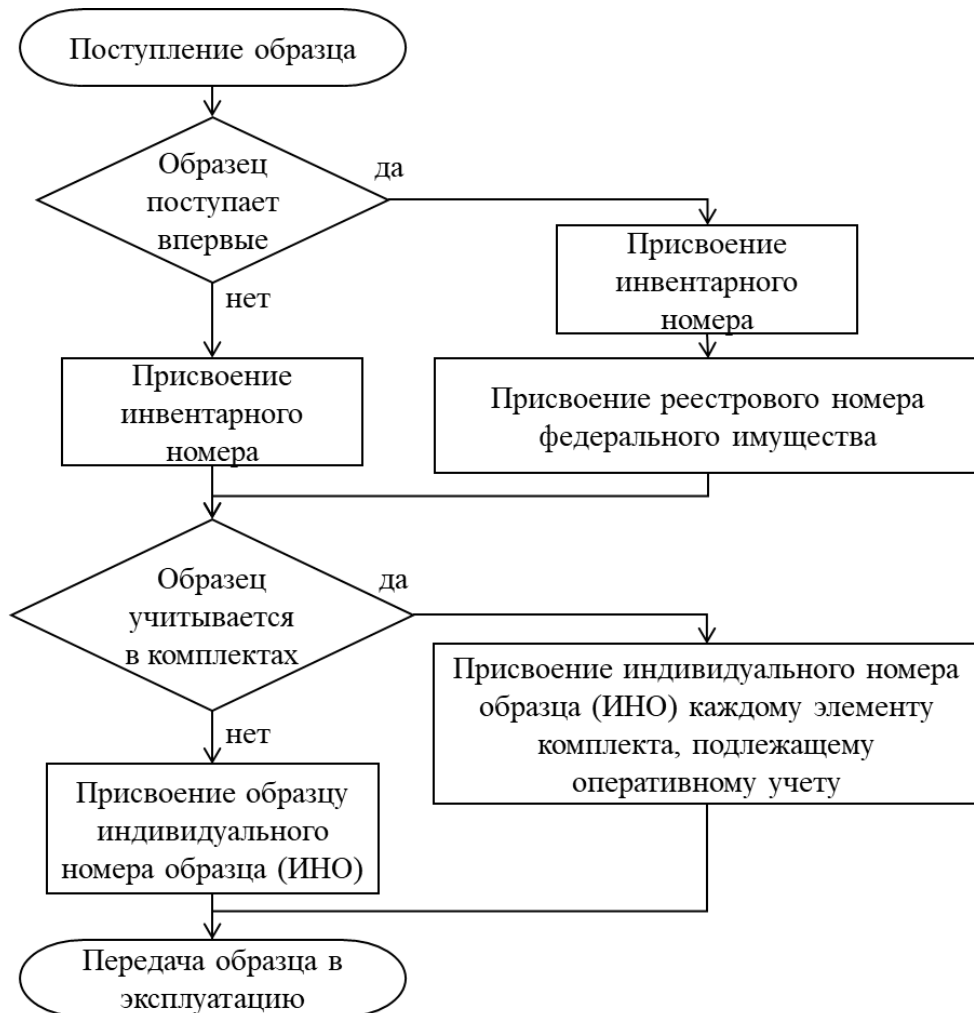
Рисунок 4.5 – Блок-схема алгоритма присвоения индивидуального номера образца
