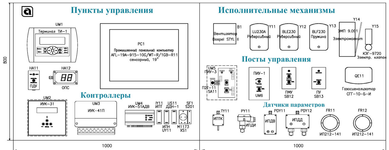
Рисунок 8 – Схема расположения оборудования на автоматизированном стенде АККИ АСУ ППЗ
