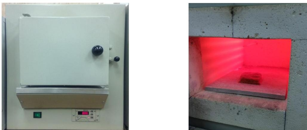
Рисунок 2.2 – Муфельная печь и тепловая камера
