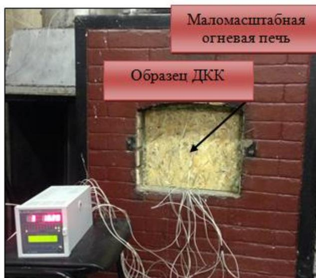
Рисунок 5.1 – Вид маломасштабной «Огневой печи» перед началом эксперимента
