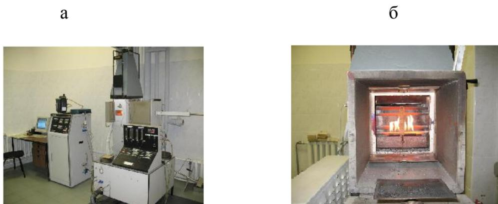
Рисунок 2.1 – Проточный калориметр (ASTM E906): *а* – общий вид;
