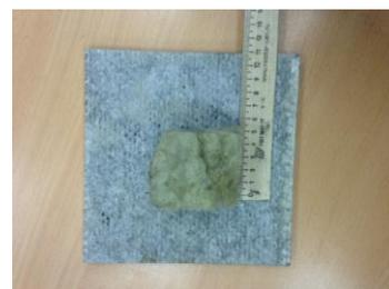
Рисунок 4.1 – Измерение геометрических размеров теплоизоляции до испытания
