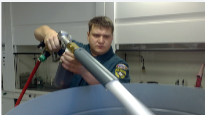
2010 Доцент кафедры С. А. Макаров при апробации разработанных методов определения пенообразующей способности пенообразователей
