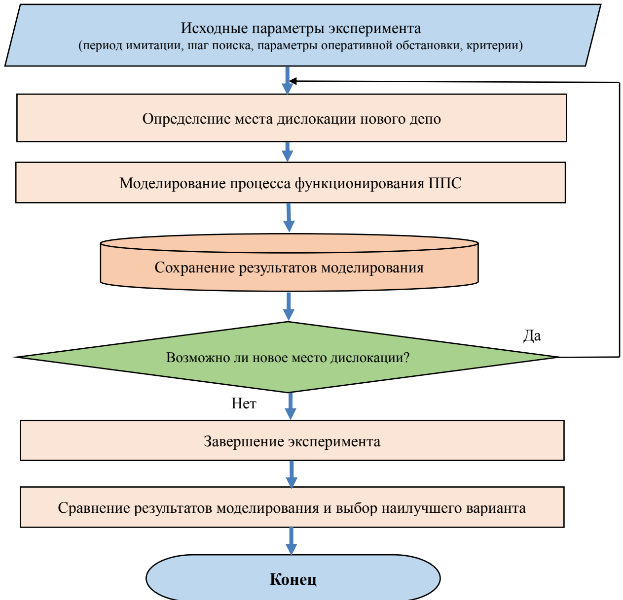
Рисунок 4.5 – Алгоритм проведения эксперимента по определению места дислокации нового депо
