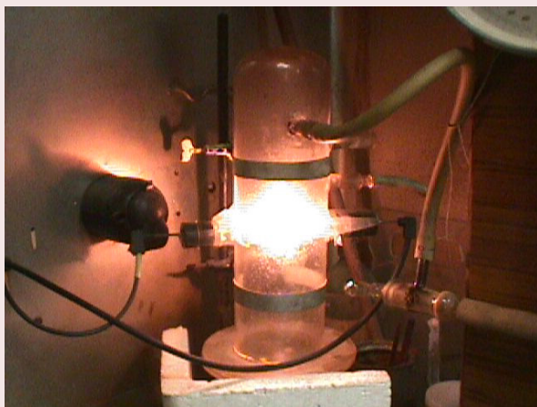
Экспериментальные установки по исследованию пожарной опасности альтернативных хладонов и фотовоспламенения хлорсодержащих горючих смесей
