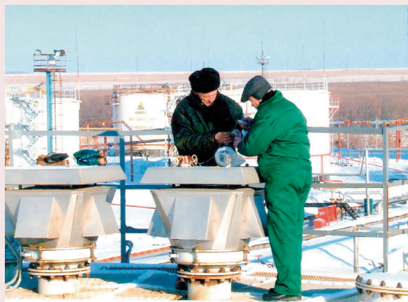
Снятие образцов, установленных внутри резервуара с сернистой нефтью
